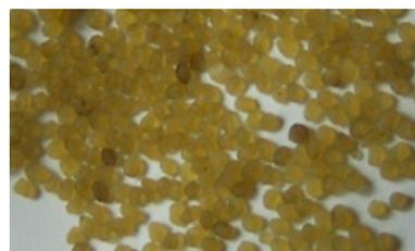
注: 异烟肼-聚乳酸-羟基乙酸微球分散均匀圆整, 球形度较好。
